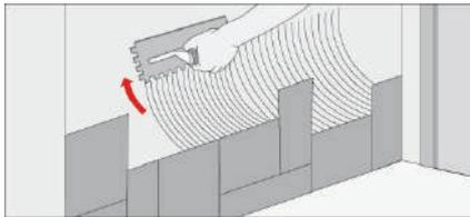
Para formatos superiores al 30 x30cm se recomienda la técnica de doble encolado, que consiste en lo siguiente; sobre el reverso del material extender una fina capa de mortero y además en la superficie.
