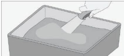
Extender el mortero sobre la área a instalarse y peinar con llana dentada para la regularización del espesor y asegurar una buena distribución por toda la superficie.
