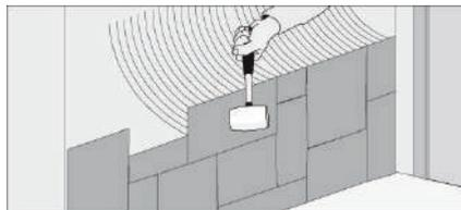
Cuando el material se instala en piso dejar una junta de 1.5mm en interiores y de 3mm en exteriores, con la finalidad de absorber posibles dilataciones o contracciones producidas por diferencias de temperatura ambiente y por supuesto, respetando las juntas de construcción, tanto perimetrales como internas.
